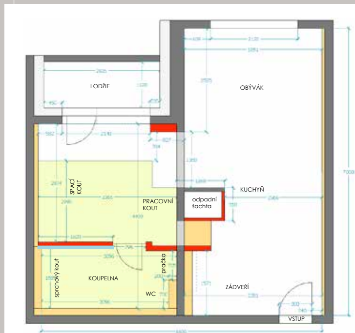
Návrh stavebních úprav - změna 1+1 (40 m 2 ) na garsonku (37,5 m 2 )
